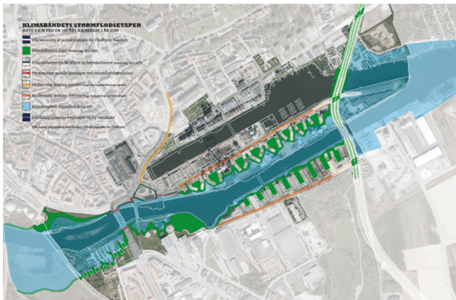
Klimabåndet og Klimabroen beskytter midtbyen mod stormflod og sikrer et forsinkelsesbassin til regnvand i det nordlige havnebassin
